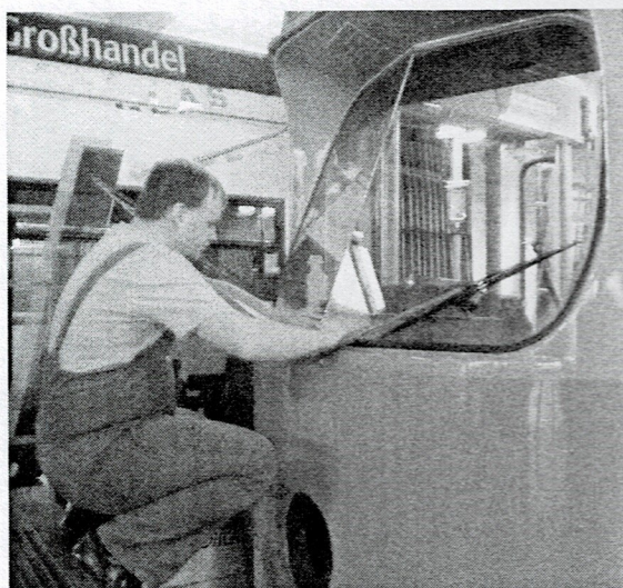
Die Arbeiten sind im vollen Gange: Sorgfältig wird die geteilte Windschutzscheibe eingesetzt und abgedichtet. Bild: Christoph Heine
