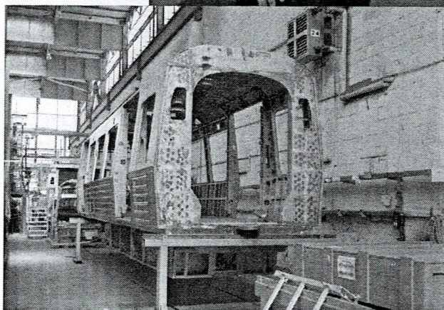
Fertigung eines Mittelwagens.
