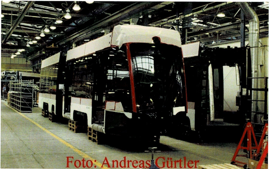
Vormontierte Wagenkästen, die zwischengelagert sind, bevor sie in die Endfertigung kommen.
