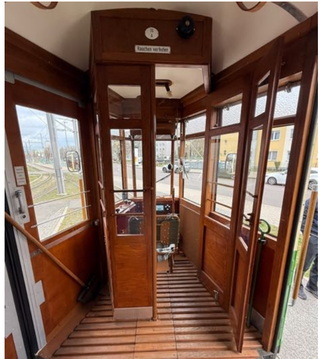
Führerstand, links die Drucktastensteuerung, rechts die Hebelhandbremse; rechtes Foto: Plattform 1
