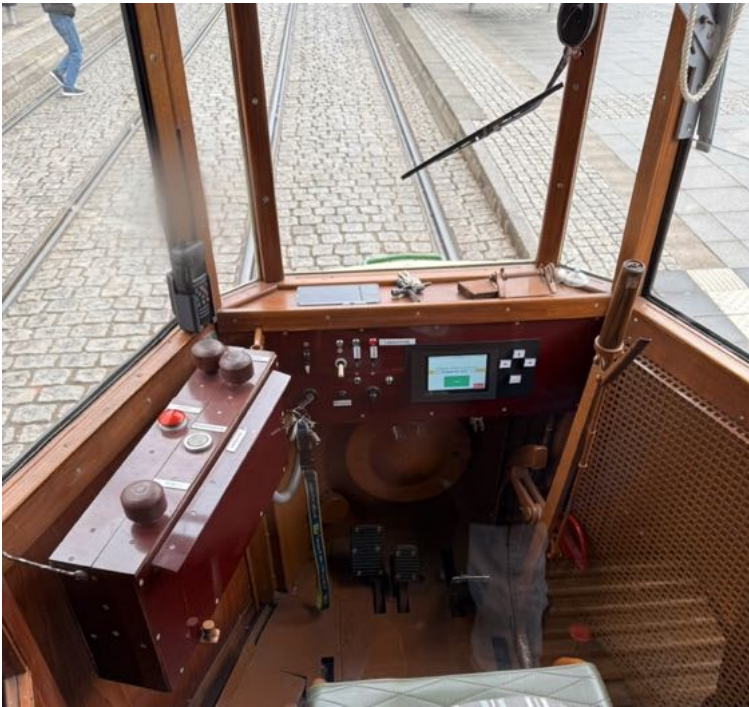
Führerstand, links die Drucktastensteuerung, rechts die Hebelhandbremse; rechtes Foto: Plattform 1
