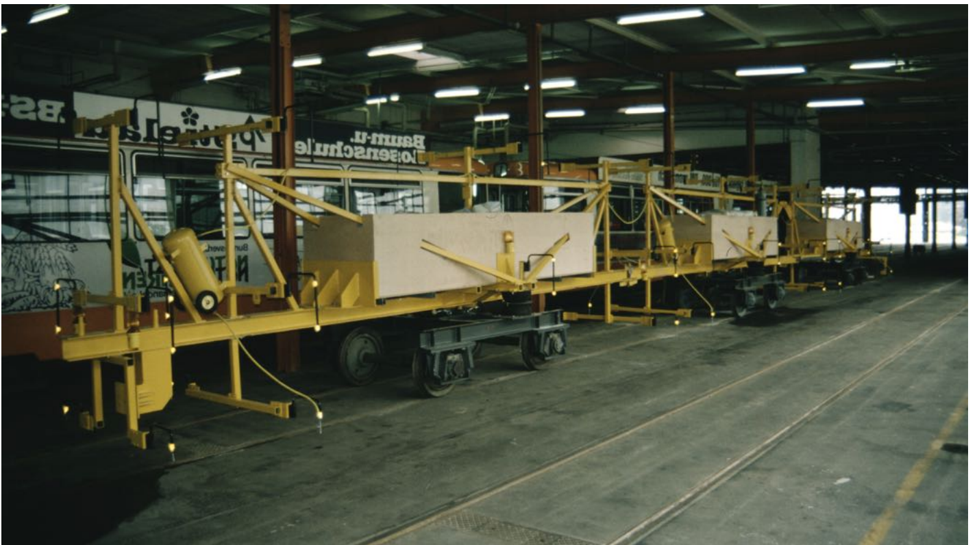
Das „Phantom“, ein Profilmessfahrzeug, befindet sich bereits im Jahr 1993 im Betriebshof Altewiek und kommt nachts zum Einsatz.
