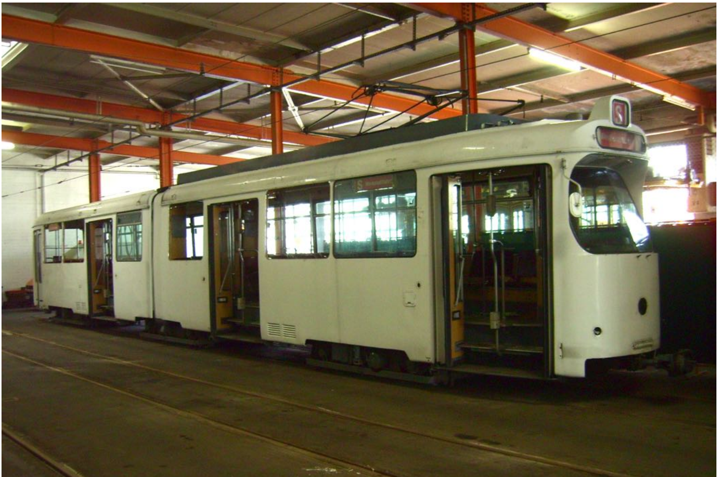
Der Wagenkasten wurde komplett abgerüstet und für den Lackiervorgang vorbereitet.
